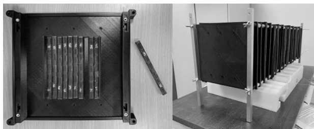
Рис. 2. Регистрирующий нейтронный модуль и собранный макет конструкции МСДН
