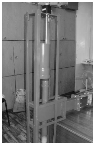
Рис.1 Специальная волноводная нагрузка с установленной на ней системой подачи раствора
