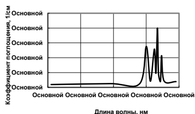
Рис. 1. Коэффициент поглощения ксеноновой плазмы в УФ диапазоне.
