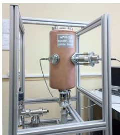
Рис. 1. Полуволновые резонаторы 325 МГц: (а) медный прототип резонатора с криостатирующим кожухом; (б) ниобиевый резонатор на этапе изготовления.
