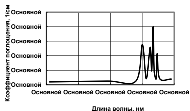
Рис. 1. Коэффициент поглощения ксеноновой плазмы в УФ диапазоне.
