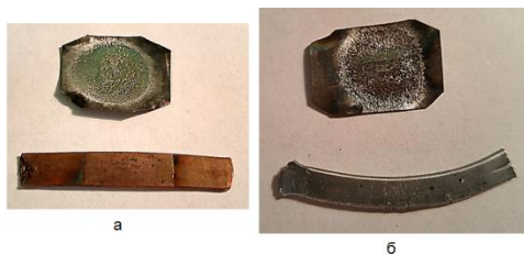
Рис.1. Фотография образцов лент MgB_2 в оболочках из меди (а) и алюминия (б) после холодной прокатки и последующего ударно-волнового воздействия плазмы на расстоянии 30 мм от анода, количество импульсов равно =5. На фото представлены также изображения поверхности защитных прокладок из титана.
