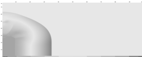
Рис.3. Поле давления, рассчитанное по 2D-CFD модели на момент времени 0.05 с (2D)
