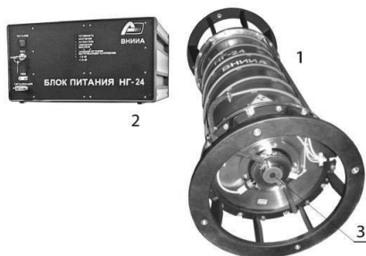
Рис. 1. Генератор нейтронов НГ-24. 1 – устройство излучения, 2 – блок питания, 3 – мишень
